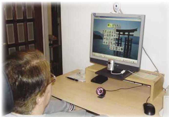
Através de processamento digital de imagem, a aplicação determina a posição exacta dos olhos, como demonstra a Figura 1, cujas coordenadas servirão para fazer um mapeamento directo das coordenadas do cursor do rato, no ecrã do computador.
