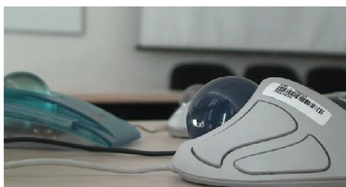
O **trackball** é um dispositivo de acesso alternativo ao computador, com funções semelhantes às do rato standard. O trackball permanece imóvel enquanto o utilizador manipula uma esfera, geralmente localizada na parte superior do periférico, de modo a mover o cursor
