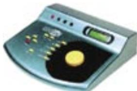
O SoundBeam é um aparelho que utiliza sensores ultra-sónicos para detectar, a uma distância de até 6 metros e sem contacto físico, a direcção, a velocidade e a distância de movimentos corporais e que traduz esses dados em música, por meio de uma ligação a um teclado electrónico, um misturador ou um módulo de som.
